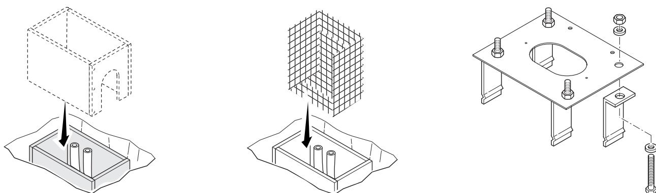
Установите монтажное основание поверх железной сетки.
