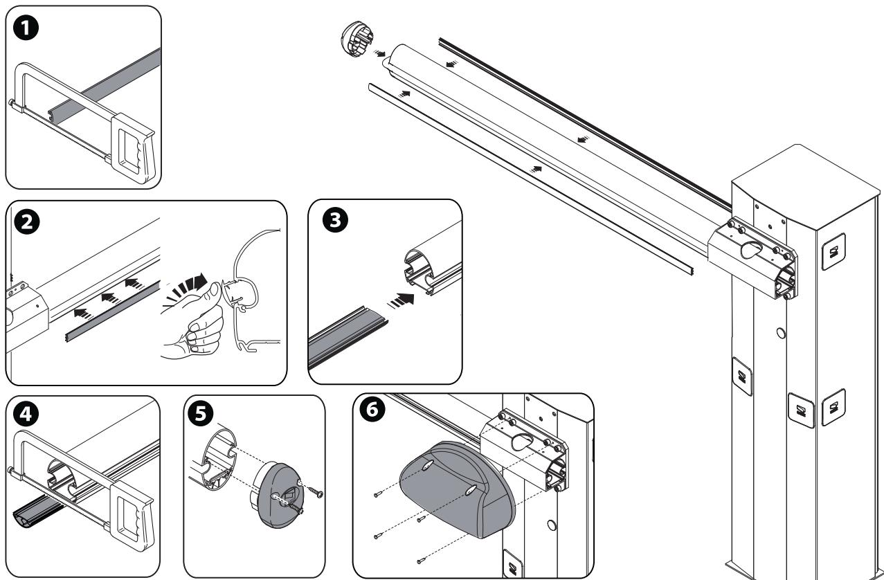
Примечание: для монтажа со стрелой 001G0402 вставьте и закрепите две уплотнительные прокладки (в комплекте со стрелой) в крепление стрелы так, как показано на рисунке.
